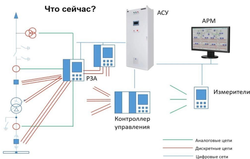
Рисунок 1 - Схема РЗА сегодня
