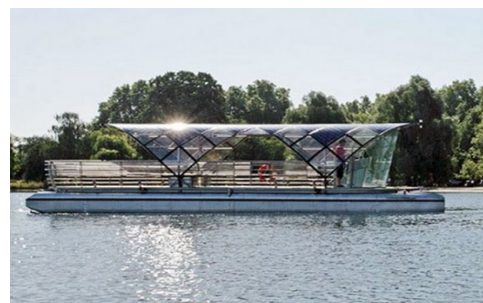
Рисунок 7. Экологически чистый речной трамвайчик, оборудованный солнечными батареями
