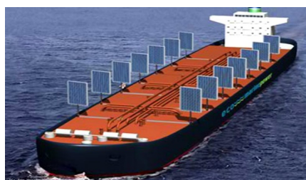
Рис. 4 - Пример использования парусов, совмещённых с солнечными панелями для обеспечения энергией судна
